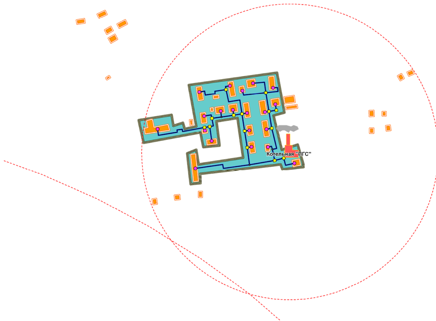
Рисунок 3 – «Зона действия котельной «ПГС»
